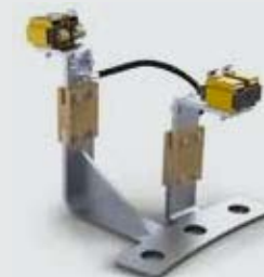
CONCEPTION BANC DE TEST JEU DE BAGUES
